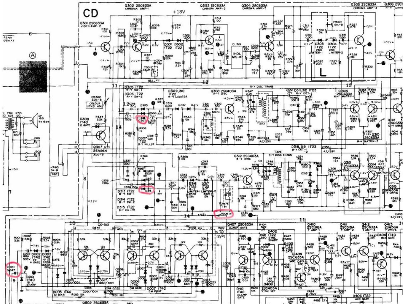
Les quatre composants à dessolder sont entourés en rouge sur l'extrait de schéma.
